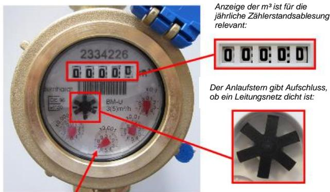
Rote Zeiger zeigen Teile eines Kubikmeters an, die für die jährliche Ablesung nicht relevant sind.
